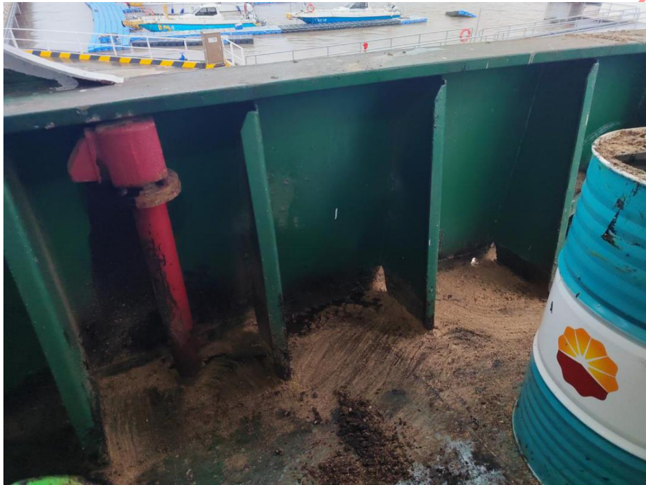
图 7：甲板溢油位置现场图
