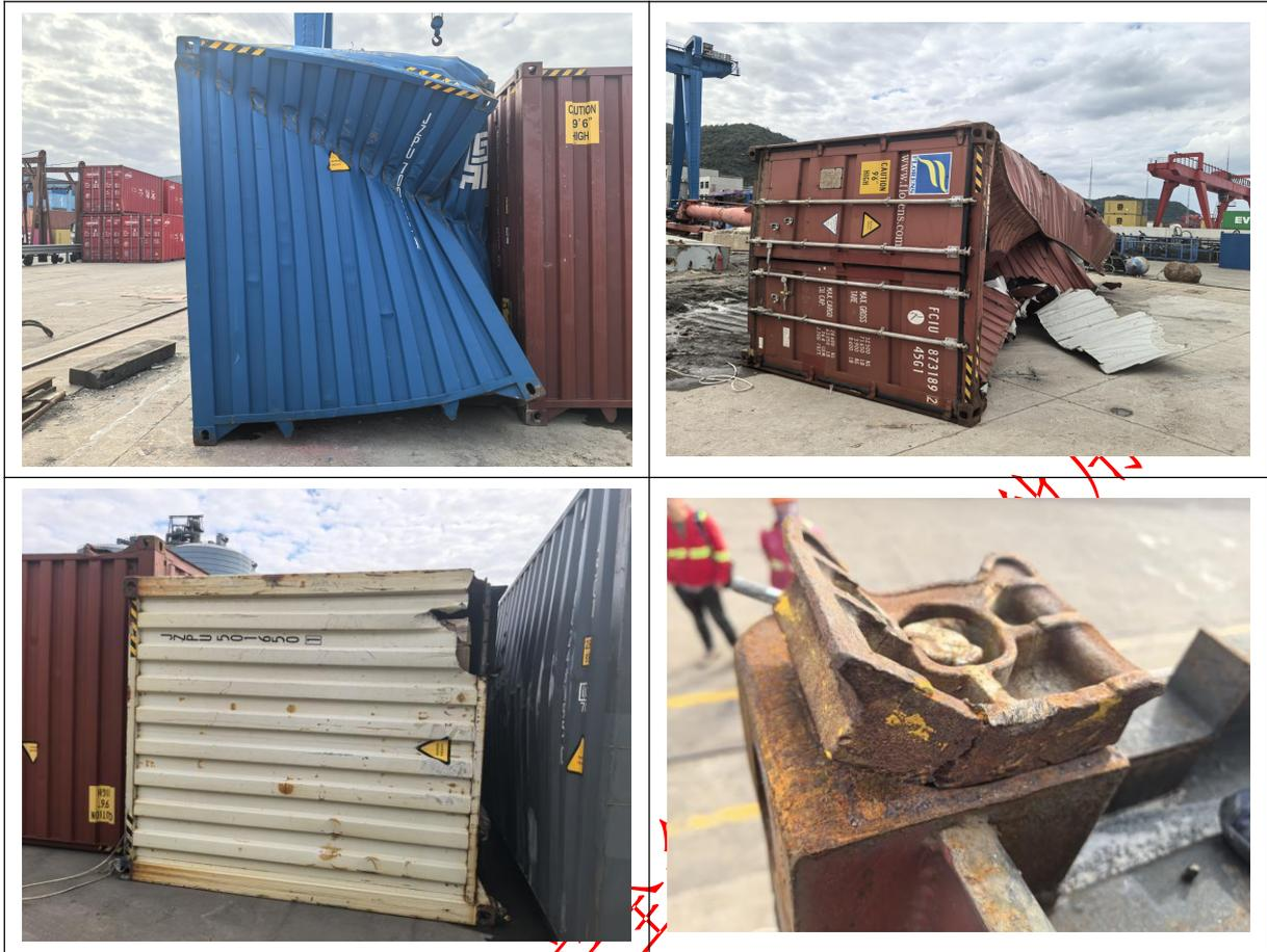
图组 2：被打捞起的落海集装箱损坏情况
