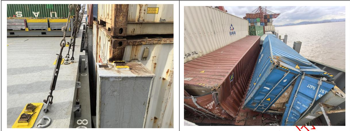
图组 3：船舶底锁、立柱损坏情况
